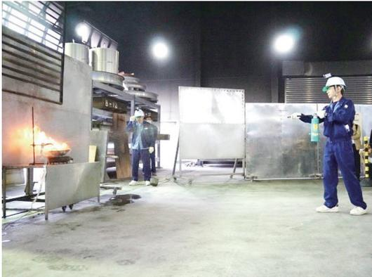
写真-2 住宅用消火器による天ぷら油火災の消火実演
