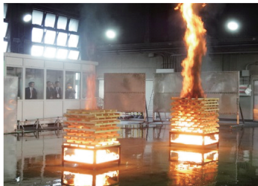
消火器のA火災消火試験実演
