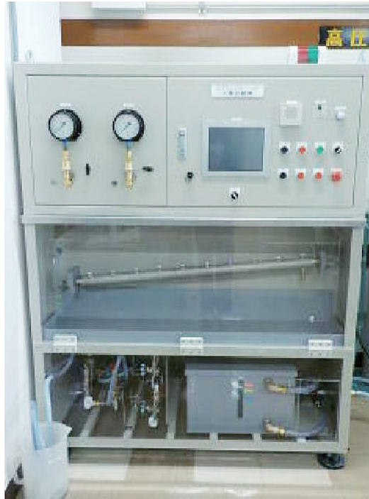
写真-4 水撃試験機（新設）
