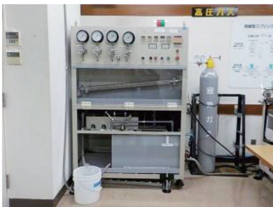
写真-1 水撃試験機（既設）
