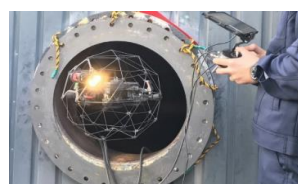
【デジタル技術を活用した効果的な予防保全の例 (ドローンを用いたタンク内部の点検)】
