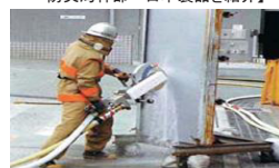
【消防防災科学技術研究推進制度の研究 成果(高水圧駆動カッター)】
