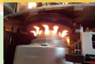
異常燃焼が火災に発展した石油ストーブの構造不具合に関する調査報告
