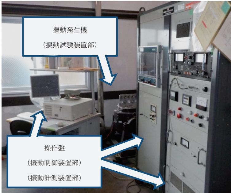
図 1：振動試験装置（旧設備）
