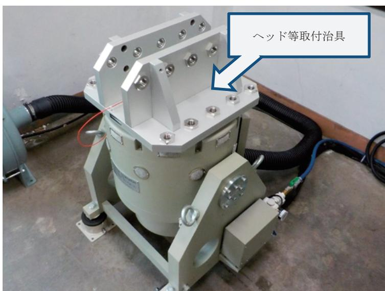
図4：振動発生機全体（新設備）
