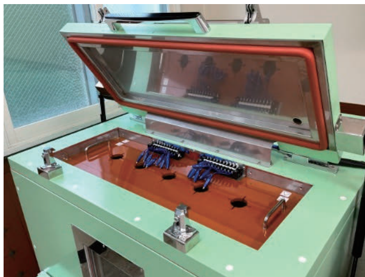
写真6 試験箱扉部（試料取付部）
