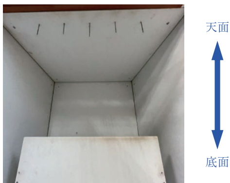
写真8 温度測定部（試験箱内）
