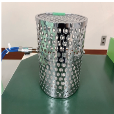
写真9 温度測定部（室温計測用）
