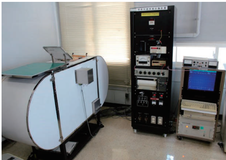
写真1 煙感知器感度試験機（光電式住警器）
