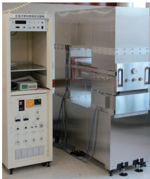
写真2 熱感知器感度試験機（定温式住警器）
