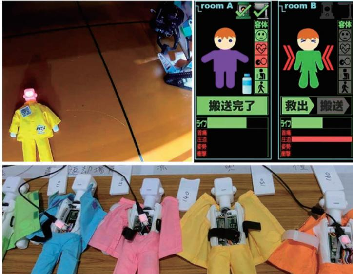
図4 競技で使用する要救助者を模擬したレスキューダミー（愛称：ダミヤン）
