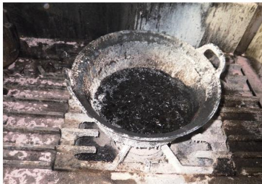
写真1-2 出火した鍋の焼損状況
