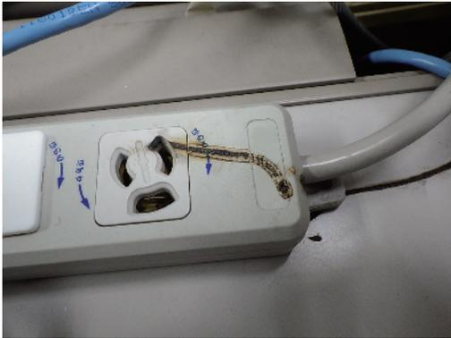
写真2-2 テーブルタップの焼損状況
