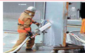
【消防防災科学技術研究推進制度の研究 成果(高圧水駆動カッター)】
