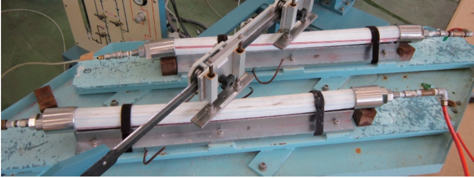
写真3 耐摩耗性試験用治具に消防用ホースを装着した状態
