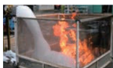
【泡消火実験の様子】
