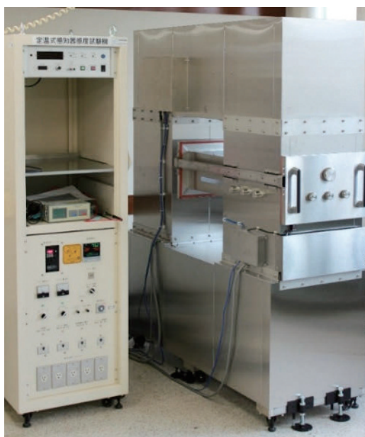
写真2 定温式住警器の感度試験機
