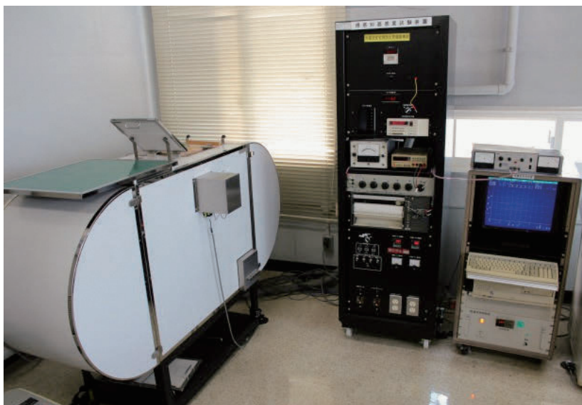
写真1 光電式住警器の感度試験機
