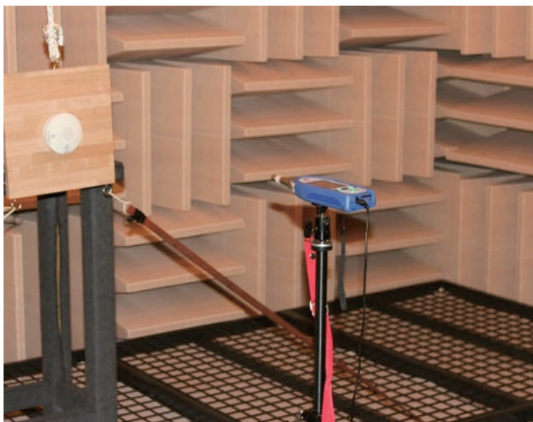
写真3 音圧測定試験
