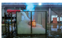
【泡消火実験の様子】
