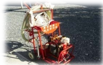
可搬消防ポンプ
