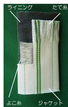
図1 消防用ホースの構造(例)
