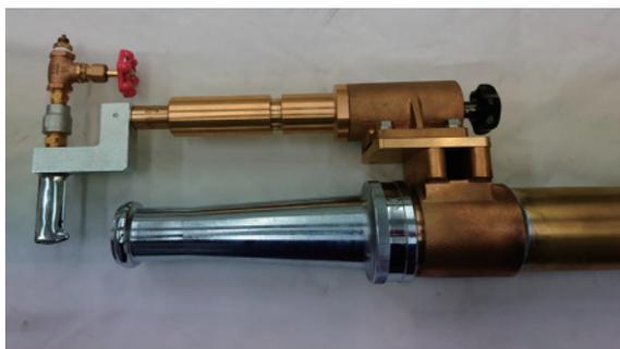
写真5 ピトー管距離調整部全体
