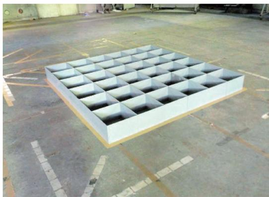
水道連結型ヘッド散水分布試験装置
