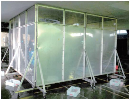
壁面散水分布試験装置
