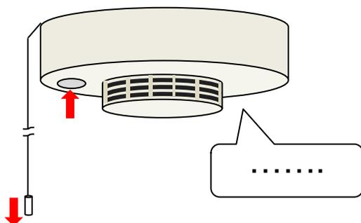
「ボタンを押す」又は「引きひもをひく」などの点検で作動しない場合は、電池切れや機器の故障の可能性がありますので、交換をおすすめします。
