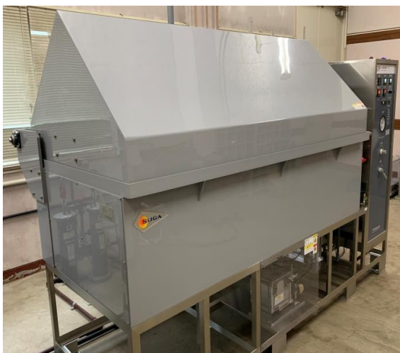
写真-1 塩水噴霧試験機全体
