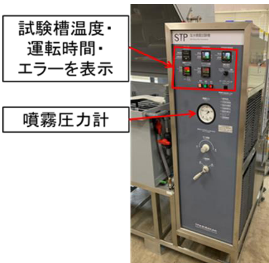
写真-3 制御・操作盤
