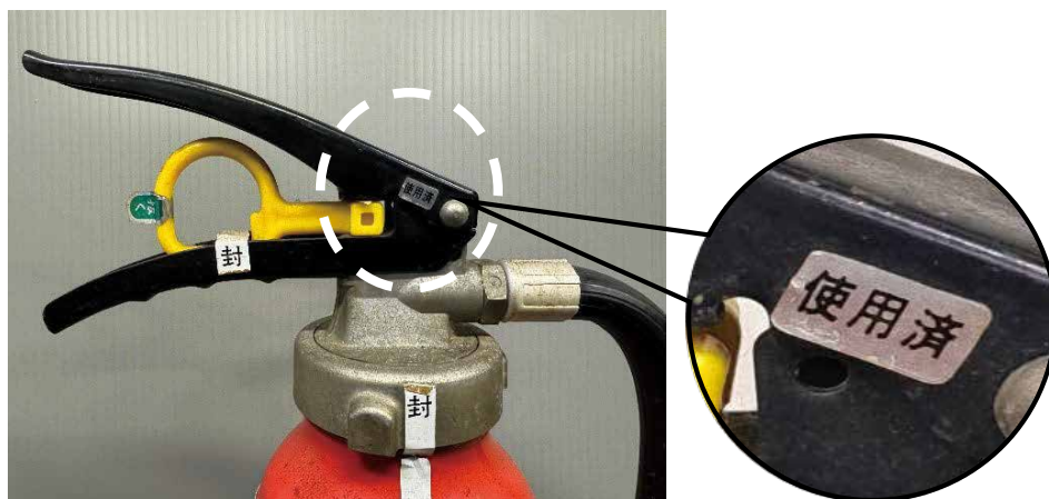
写真2-3-3② 判別できる装置がない（使用済の表示が見える）
