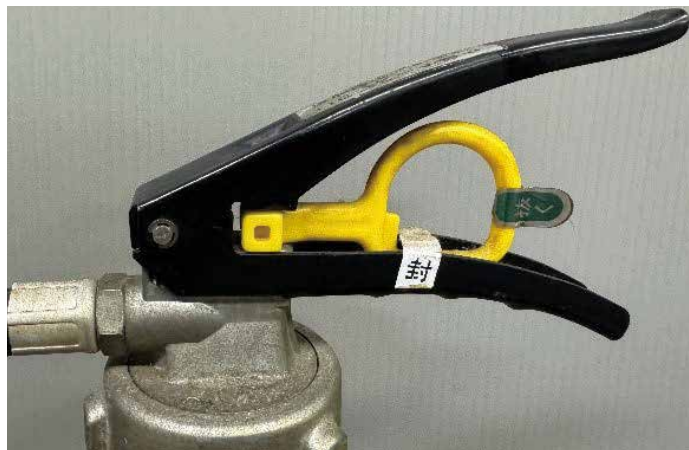
写真2-4⑤ 型式失効した消火器（安全栓が上向き式でない）
