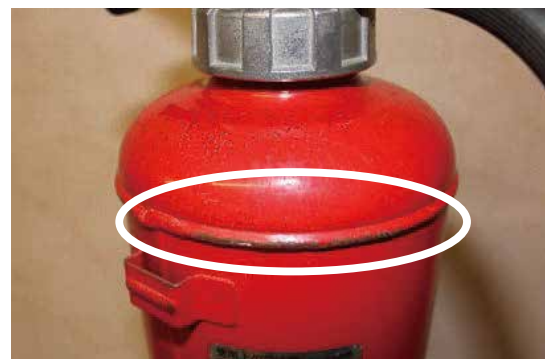
写真2-2④ 上部の腐食
