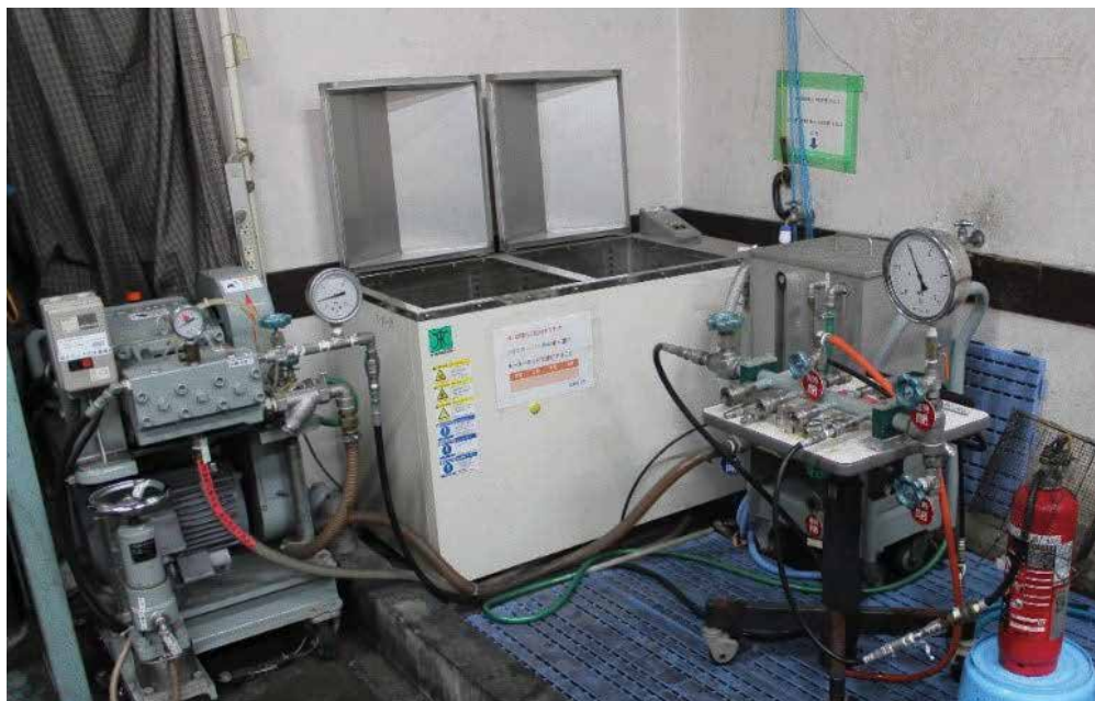
写真1-3⑦ 耐圧試験の様子
