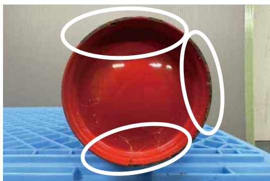
写真2-2① 底部の腐食
