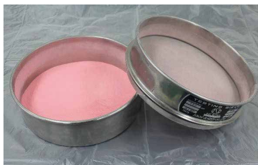
写真2① 粒度試験後（99％以上通過）
