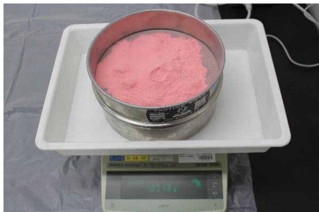
写真1-2② 粒度試験の実施前の様子
