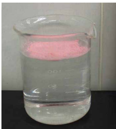
写真1-2⑥ 沈降試験の様子
